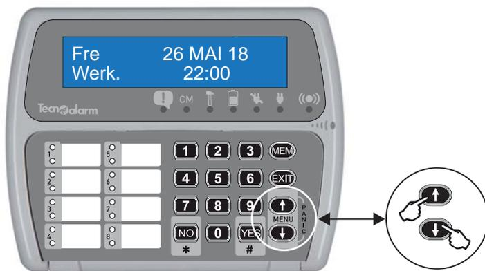
Der Panikalarm wird durch gleichzeitiges Drücken der Tasten „Pfeil nach oben“ und „Pfeil nach unten“ ausgelöst.
